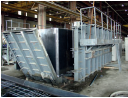
Figuras 5, 6 y 7: sistema de encofrado de Toyota sin división del núcleo interior
